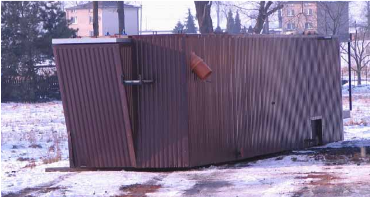
Fot. 6. Biogazownia kontenerowa przed ustawieniem w gospodarstwie
